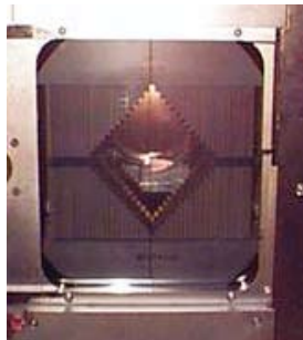
Ryc. 9.19. Spojrzenie w głąb głowicy przyspieszacza – widoczny wielolistkowy kolimator MLC ( multi leaf kolimator ) – kontrolowany komputerowo system wysuwających się listków kształtujących pole napromieniane – podstawa techniki IMRT w systemie Variana.
