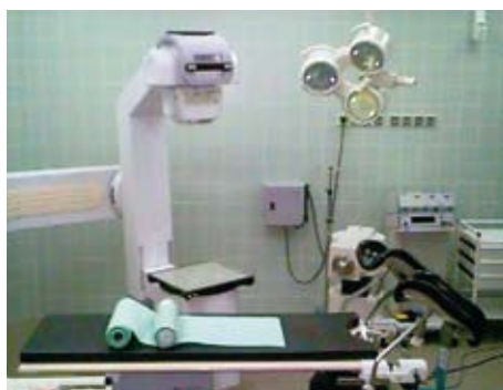
Ryc. 11.7. Zdjęcie IBU z Zakładu Brachyterapii w Gliwicach (udostępnione przez dr n. med. Brygidę Białas, kierownika Zakładu Brachyterapii w Gliwicach). System przestrzennej wizualizacji położenia aplikatorów w ciele pacjentki w czasie rzeczywistym.
