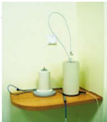
Ryc. 15.11. Układ pomiaru aktywności źródła w powietrzu i komorą studzienkową.
